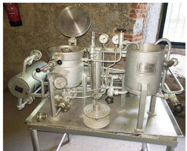
Figura 5. Instrumento para pruebas de tinte perteneciente al laboratorio de la fábrica textil NAVAZO. Marca Scholl año 1970.
