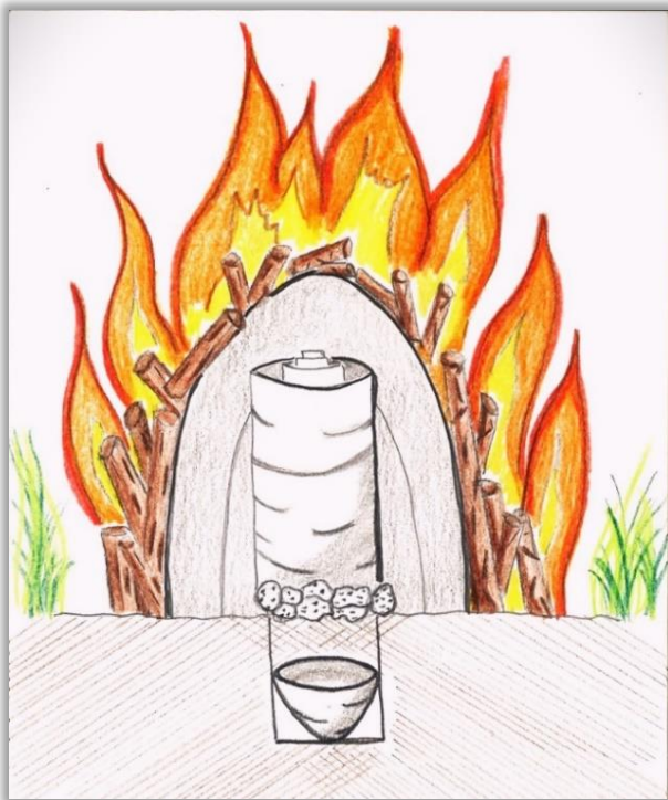
Figura 9. Ilustración del procedimiento para obtener brea mediante destilación destructiva de la corteza de abedul. Inspirado en la Figura S11 de la referencia [13]. Dibujo: J. Agúndez Rodríguez
