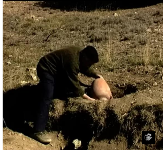
Figura 6. Colocación del cántaro lleno de astillas de enebro en el horno. [2]
