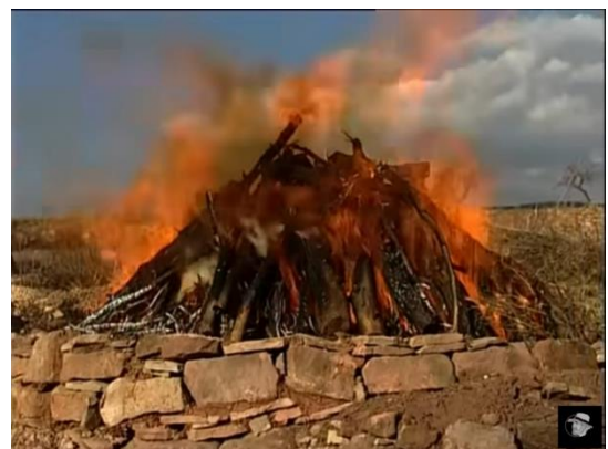
Figura 5. Hornada en proceso de destilación del aceite de enebro. [1]
